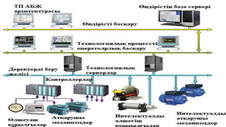
2.5– сурет – Ұсақтау кешенінің АБЖ-дағы өзара әрекеттесудің негізгі компоненттерінің схемасы
