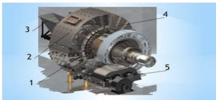
1.6- сурет – Өзін-өзі тегістеу ұнтақтау қондырғысының дизайны
