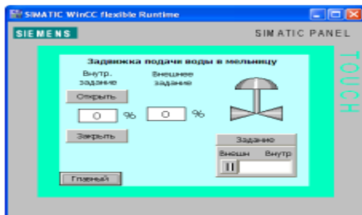
3.15 - сурет – Ұнтақтағыш құрылғыға су беруді басқару экраны
